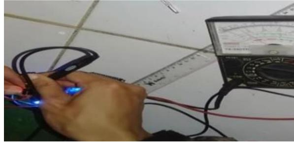
Gambar 6. Pengukuran Tegangan sensor Api
